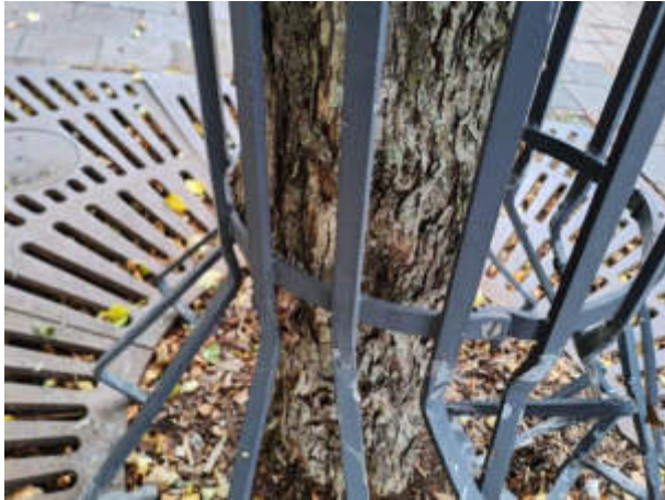
Abbildung 32: Handelsübliches Baumschutzgitter in Rosettenform. Foto: Annette Hartmann 2025
