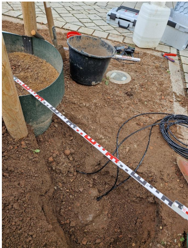
Abb. 1 & 2: Verbau von Saugspannungssensoren an einem Jungbaum - Fotos Landeshauptstadt Hannover
