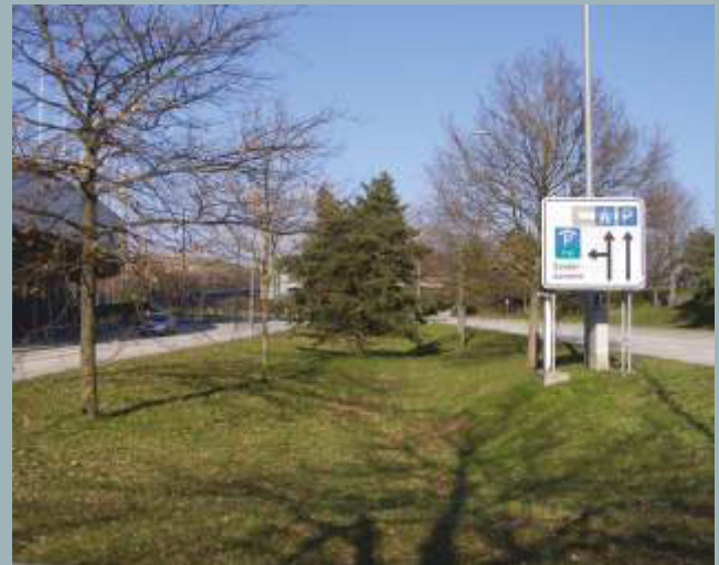
Abb. 4: Straßenbegleitende Versickerungsmulden, bei denen die Bäume mit genügend Abstand am Rand der Mulden stehen. Stauende Nässe ist weitgehend ausgeschlossen. (Foto: Leander Wilhelm, München)
